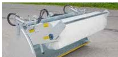
Abb. hydr. Hubvorrichtung (2 dw), PU-Schürfleiste (gegen Aufpreis) und Feuerverzinkt (optimaler Korrosionsschutz)
