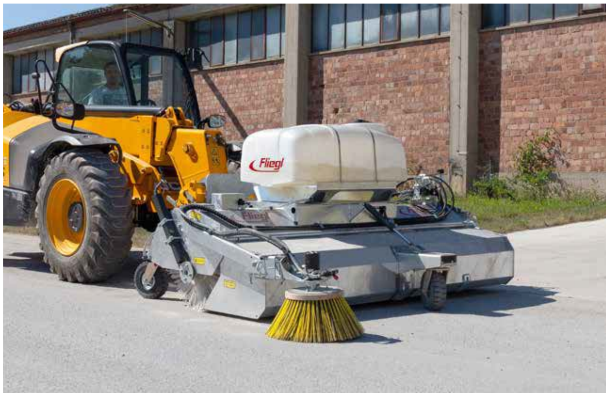
Stufenlos verstellbarer Kehrbesen, bis zur äußersten Verschleißgrenze abnutzbar
