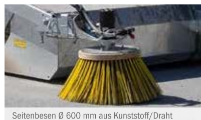
Seitenbesen Ø 600 mm aus Kunststoff/Draht
