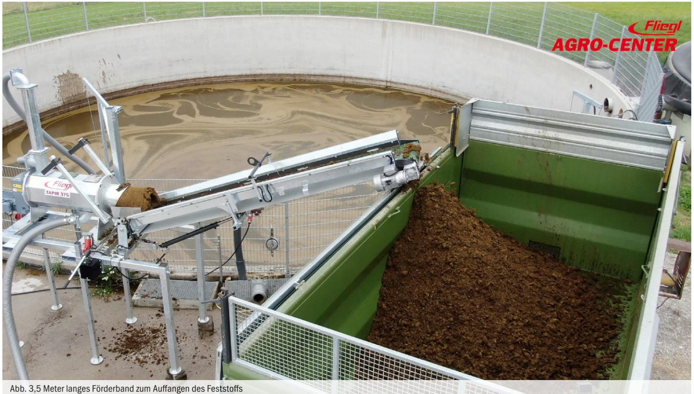
Abb. 3,5 Meter langes Förderband zum Auffangen des Feststoffs
