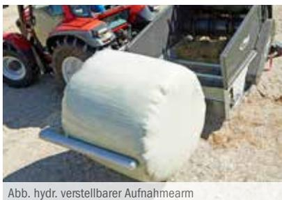
Abb. hydr. verstellbarer Aufnahmearm
