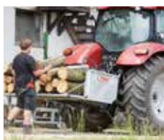
Ausklappbare Pendelwand dient als Muldenverlängerung
