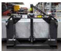
Aufnahmemöglichkeiten: Euronorm- und Dreipunkt- sowie Stapleraufnahme
