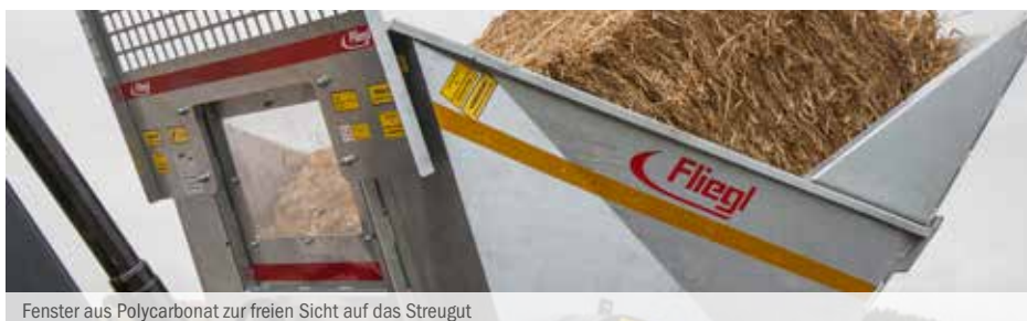
Fenster aus Polycarbonat zur freien Sicht auf das Streugut
