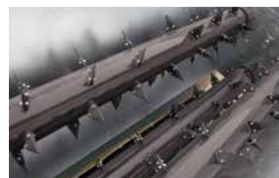
3 Dosierwalzen bestückt mit Messern
